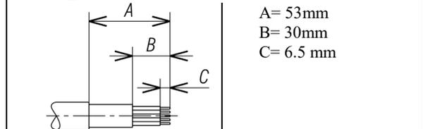
单根剥离导线必须与每个触针压接。对于电气连接和装配, 请参见图 11。
