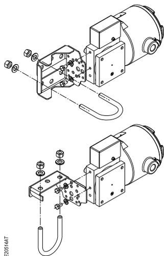
图 15-APW10-APA10-2"管道"支架的安装
