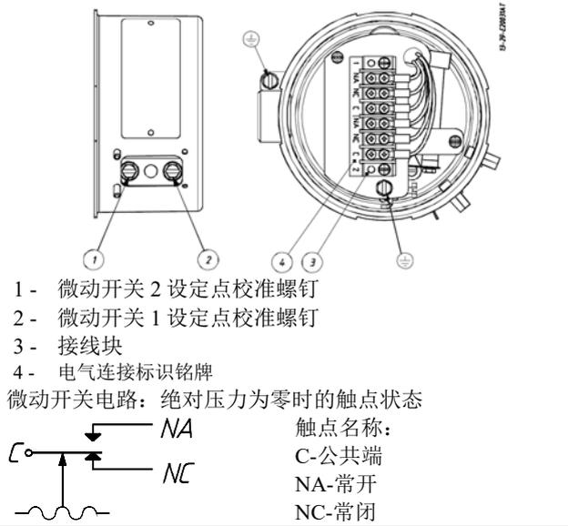
调整螺钉旋转方向的影响已在标签上说明。
