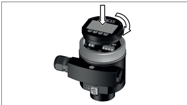
Rys. 30: Wkładanie modułu wyświetlającego i obsługowego do komory układu elektronicznego w obudowie jednokomorowej
