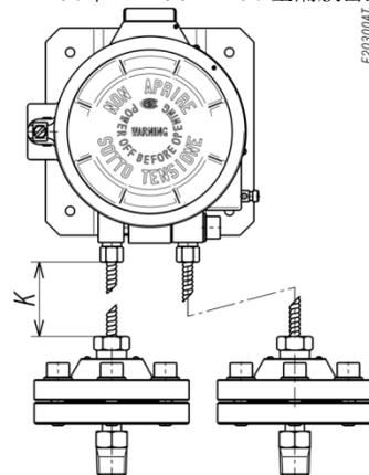
图 21 - 法兰歧管阀的安装
