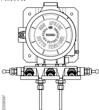
图 22 - 直接歧管阀的安装 (1/2G 螺纹)
