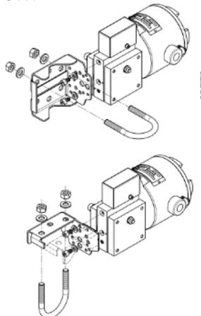
图 15 - DW10-DA10-2"管道支架的安装
