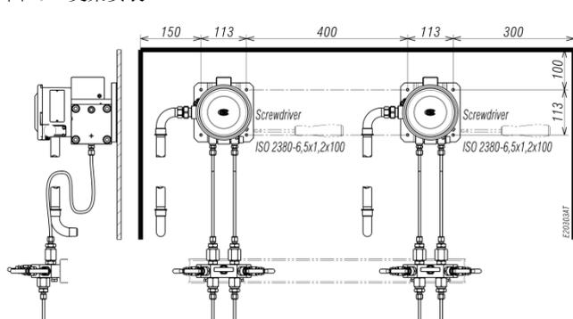
图 20 - DW496/DW197 和 DA496/DA197 型隔膜密封仪表
