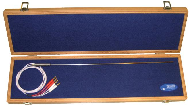
Sonde à résistance en platine de type CTP2000
