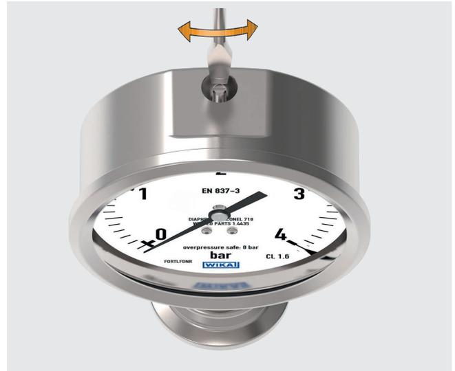
El ajuste del punto cero se puede hacer con un destornillador plano tras quitar el tapón de obturación en la parte superior de la caja.
