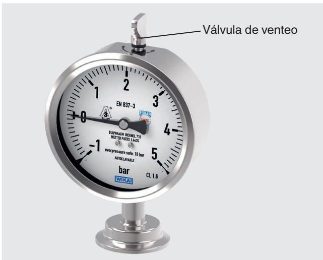
El modelo PG43SA-S con válvula de ventilación ha sido diseñado específicamente para la limpieza desde el exterior ("wash-down") con agentes químicos de limpieza especialmente agresivos en sistemas de limpieza farmacéutica (por ejemplo, lavadoras de armarios farmacéuticos).
